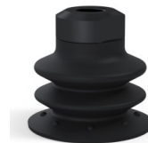
Variantenreferenz: 96 35NI 18D-2-GIC • Farbe: Schwarz • Materiale: Nitril • Shore-Härte: SH50
