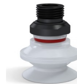
Variantenreferenz: 91 31SLT 38D-2-F • Farbe: Transluzent (Lebensmittels zertifikat) • Materiale: Silikon • Shore-Härte: SH60
