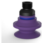
Variantenreferenz: 91 31MNT 14D-2 • Farbe: Bordeaux • Materiale: Abdruckfreies Silikon • Shore-Härte: SH60
