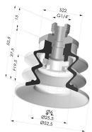
Sauggreifer 2.5 Falten Serie 96 Ø 52MM
