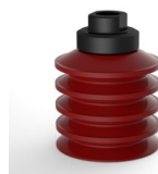
Variantenreferenz: 92 40SL F18 • Farbe: Rot (Lebensmittels zertifikat) • Materiale: Silikon • Shore-Härte: SH60
